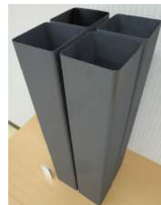
写真：SiC/SiC複合材料で製作されたBWR用チャンネルボックス
