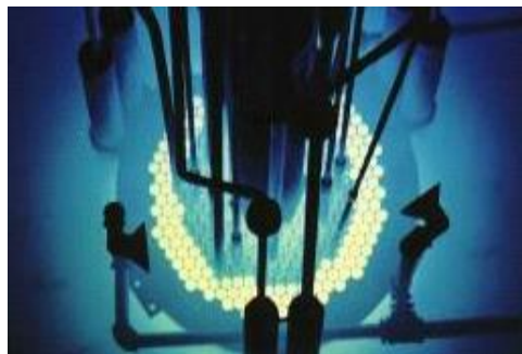
試験炉を用いた RIA模擬試験の様子*
