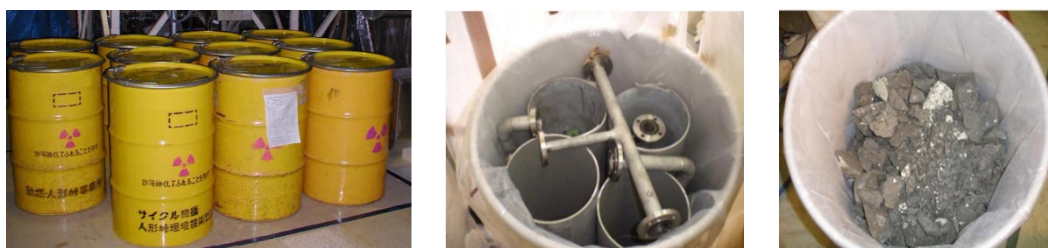
図 1 原子力施設から発生する解体物などを詰めた放射性廃棄物ドラム缶 (左：ドラム缶外観、中：金属系内容物の例、右：コンクリート系内容物例)
