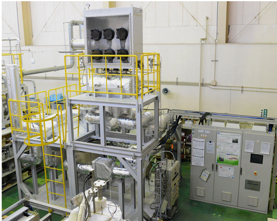
LBE高温腐食ループ (OLLOCHI)
